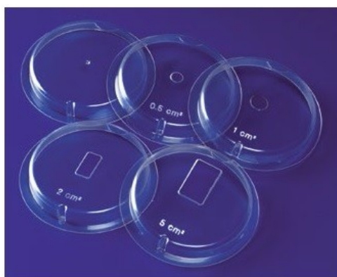
Obr. 3.2. Masky pro elektrolytické leštění [21]
