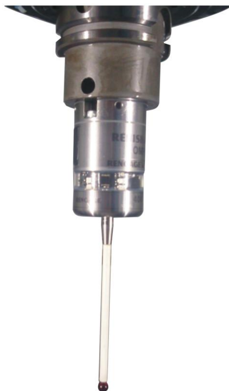
Obr. 6.5 Měřící sonda upnutá ve stroji Tajmac MCV ZPS 1210.
