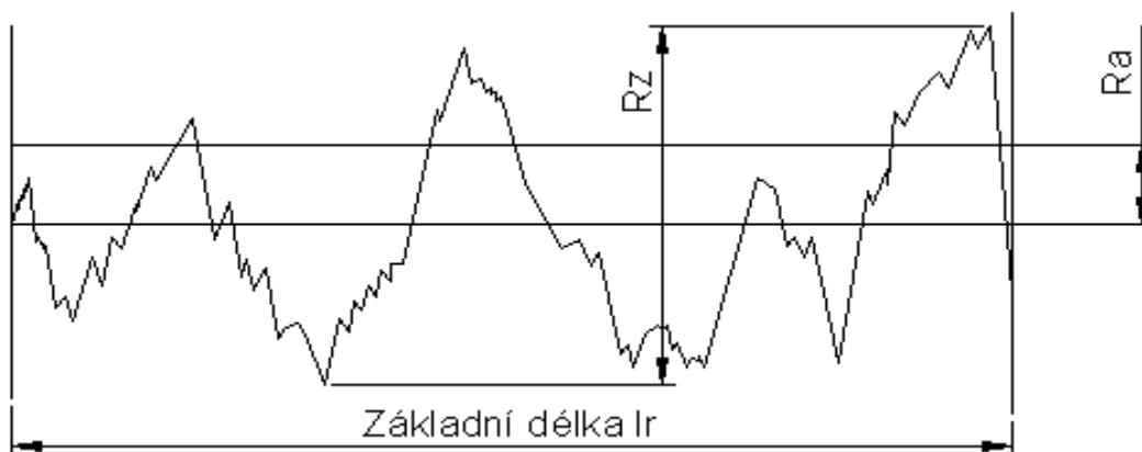
Obr. 3.2 Průměrná aritmetická úchylka Ra, maximální výška profilu Rz [25]
