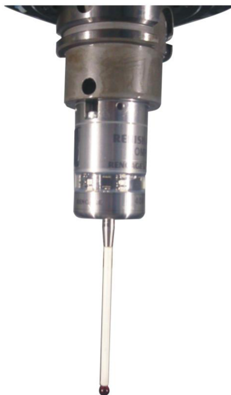
Obr. 6.5 Měřicí sonda upnutá ve stroji Tajmac MCV ZPS 1210.
