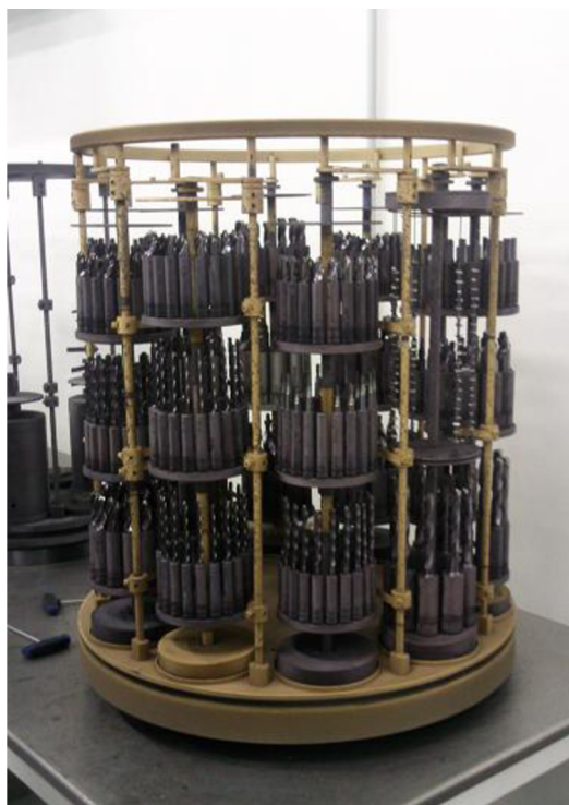
Obr. 5.2 a 5.3 Umístění nástrojů v držáku před umístěním do stroje vlevo a vpravo povlakovací stroj CC800/9ML – foto z firmy CemeCon
