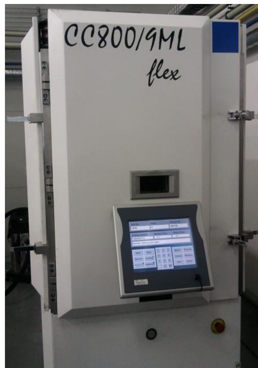
Obr. 5.2 a 5.3 Umístění nástrojů v držáku před umístěním do stroje vlevo a vpravo povlakovací stroj CC800/9ML – foto z firmy CemeCon
