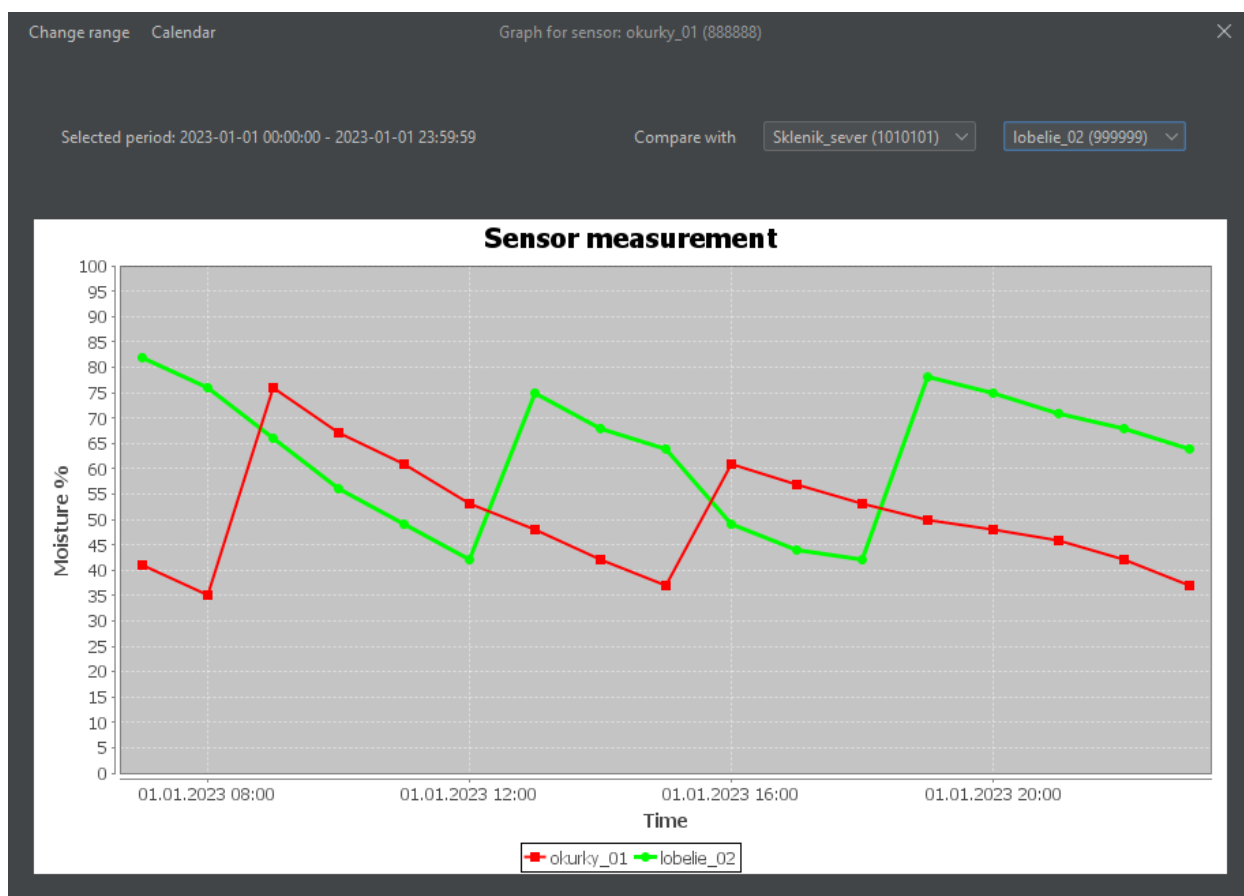
Obr 31: Okno grafu zobrazující průběh zálivky senzoru
