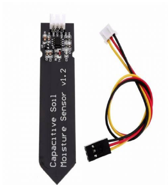
Obr 8: Půdní vlhkoměr analogový s antiko-rozní sondou V1.2
