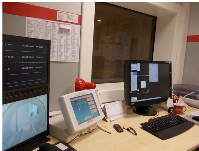
Obrázek č. 9 – ovládací konzole MR, sledovací obrazovka dýchání, ovládání automatického injektoru
