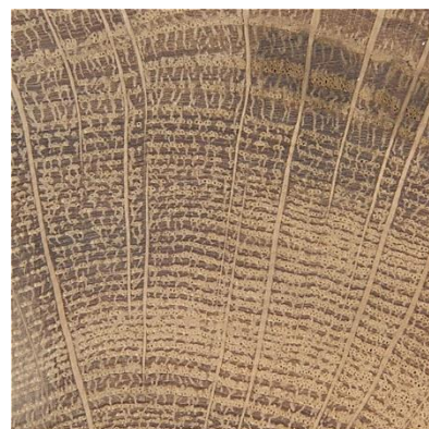
Obr. 13 Dub – příčný řez
