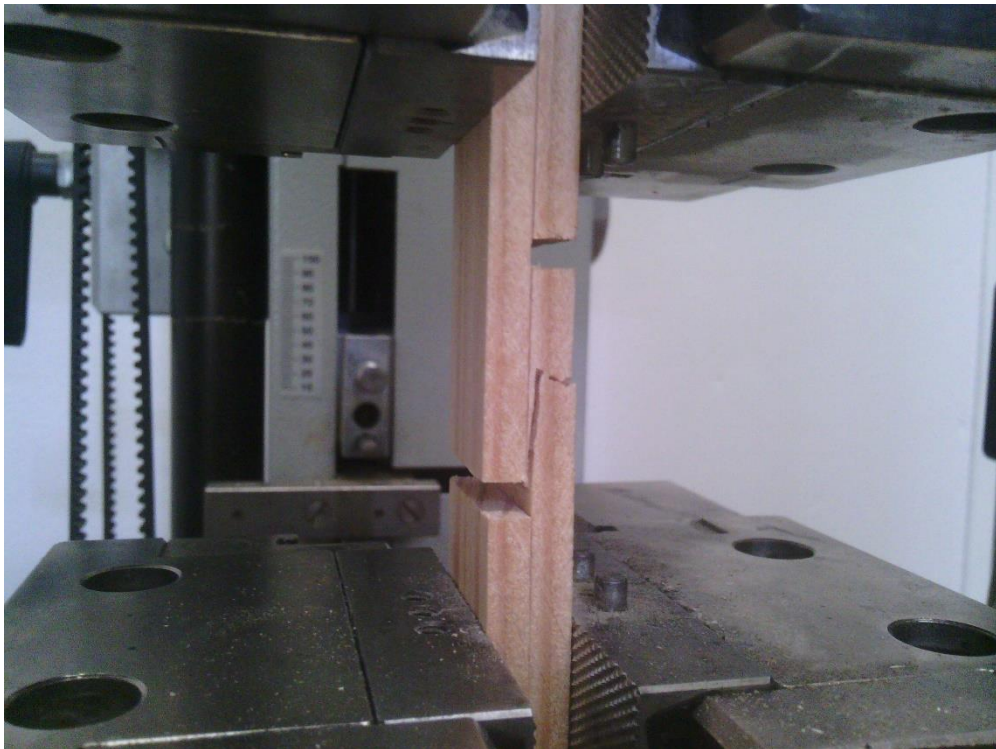
Obr. 31 Ukončení zkoušky, lom tělíska
