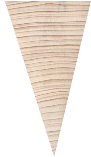
Obr. 20 Smrk – příčný řez
