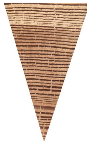
Obr. 15 Modřín – příčný řez
