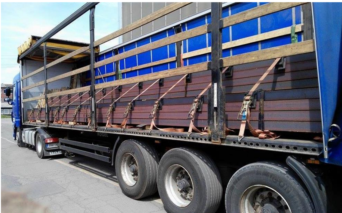
Obr. 3.3 Upevnění nákladu pomocí upínacích popruhů
