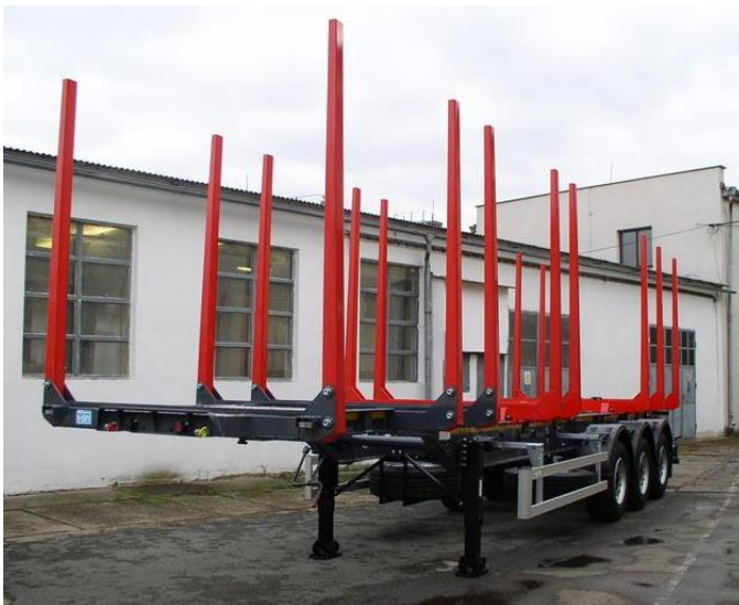
Obr. 5.7 Klanice blokující pohybu nákladu do boku (Zdroj: https://tomservice.cz )
