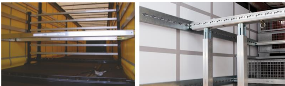
Obr. 5.2 Blokovací tyče a variabilní lišta s teleskopickou závorou (Zdroje: http://publications.europa.eu a https://www.koegel.com )
