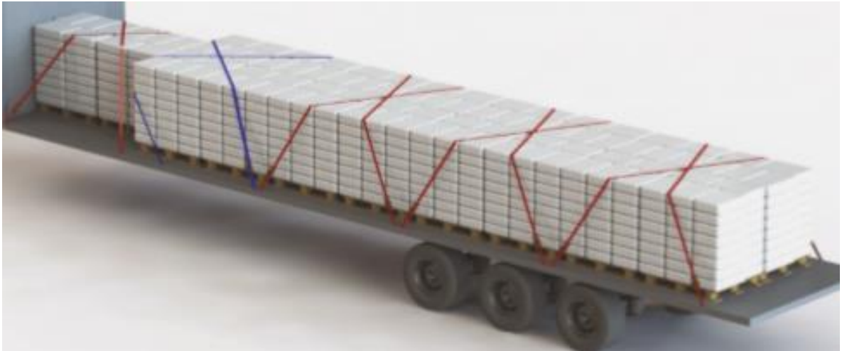
Obr. 7.9 Kombinace blokování a křížového uvázání (Zdroj: http://publications.europa.eu )
