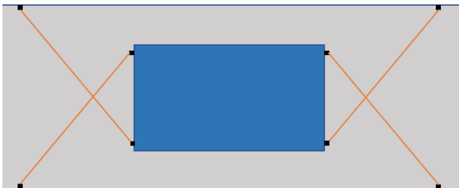
Obr. 6.5 Diagonální uvázání - pohled shora (Zdroj: vlastní zpracování)
