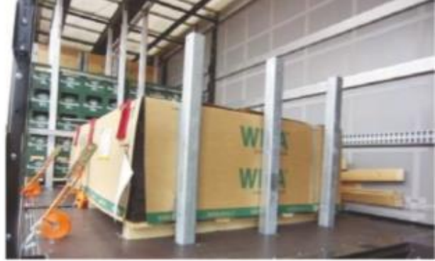
Obr. 5.6. Klanice blokující pohybu nákladu dopředu (Zdroj: http://publications.europa.eu )
