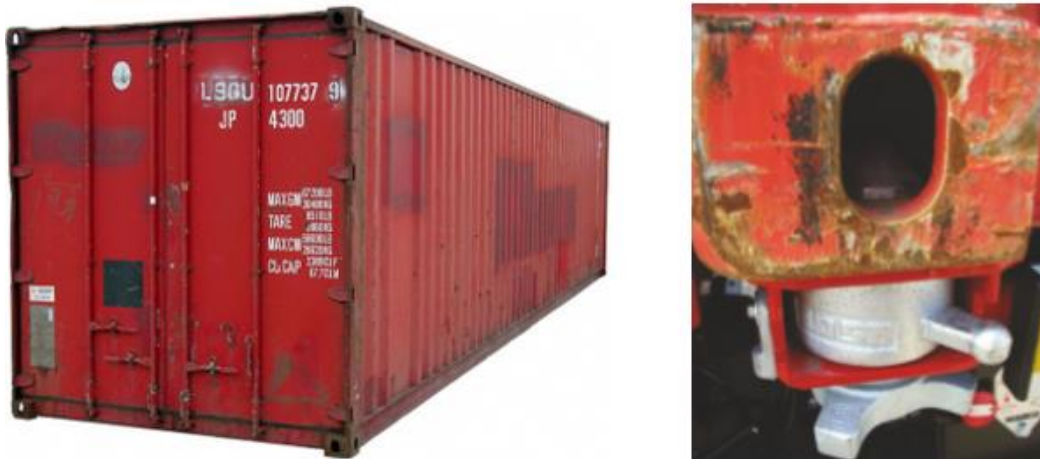
Obr. 5.9 Kontejner 40 stop a šroubovací zámek (Zdroj: https://cs.wikipedia.org )
