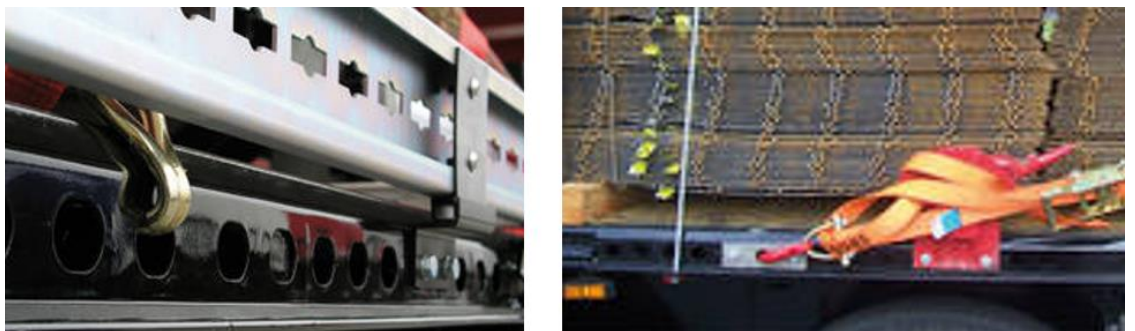
Obr. 5.4 Rám s lištou a zpevňující deska (Zdroj: https://www.koegel.com )
