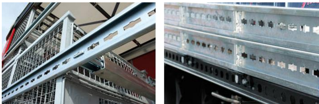
Obr. 5.1 Boční lišta a variabilní lišta pro doraz palet (Zdroj: https://www.koegel.com )
