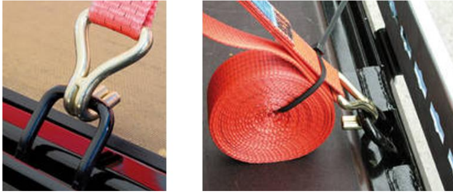
Obr. 5.3 Standardní a 4-tunové záchytné oko (Zdroj: https://www.koegel.com )
