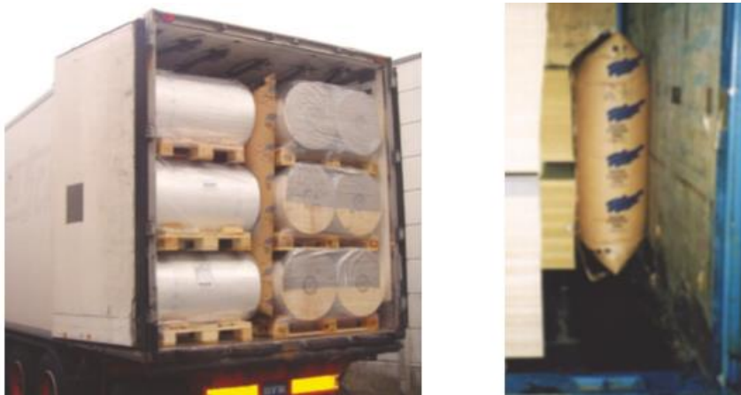
Obr. 5.8 Vertikální výplň a vzduchový vak (Zdroj: http://publications.europa.eu )
