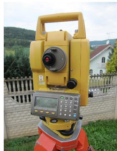
Obr. 21 – Totální stanice Topcon GPT 3003-N; zdroj: vlastní foto autorky
