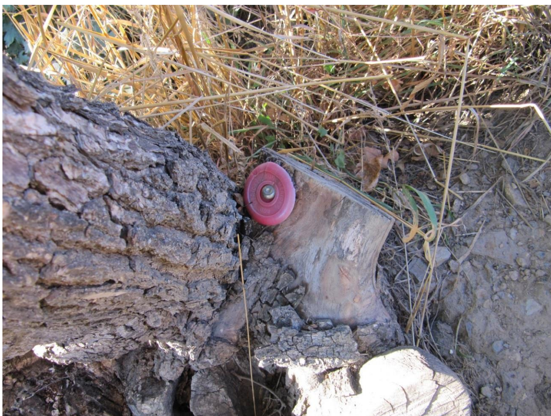
Obr. 38 – Ocelový měřický hřeb zatlučený ve stromu; zdroj: vlastní foto autorky
