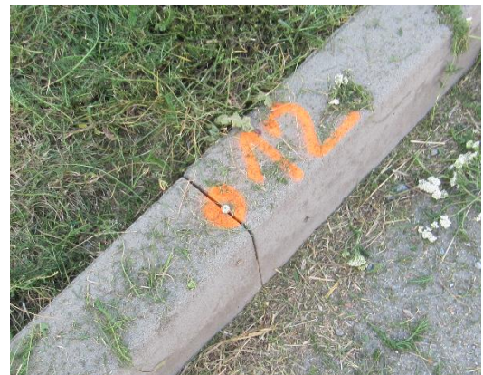
Obr. 24 – Stabilizace bodu 5012 hřebem; zdroj: vlastní foto autorky
