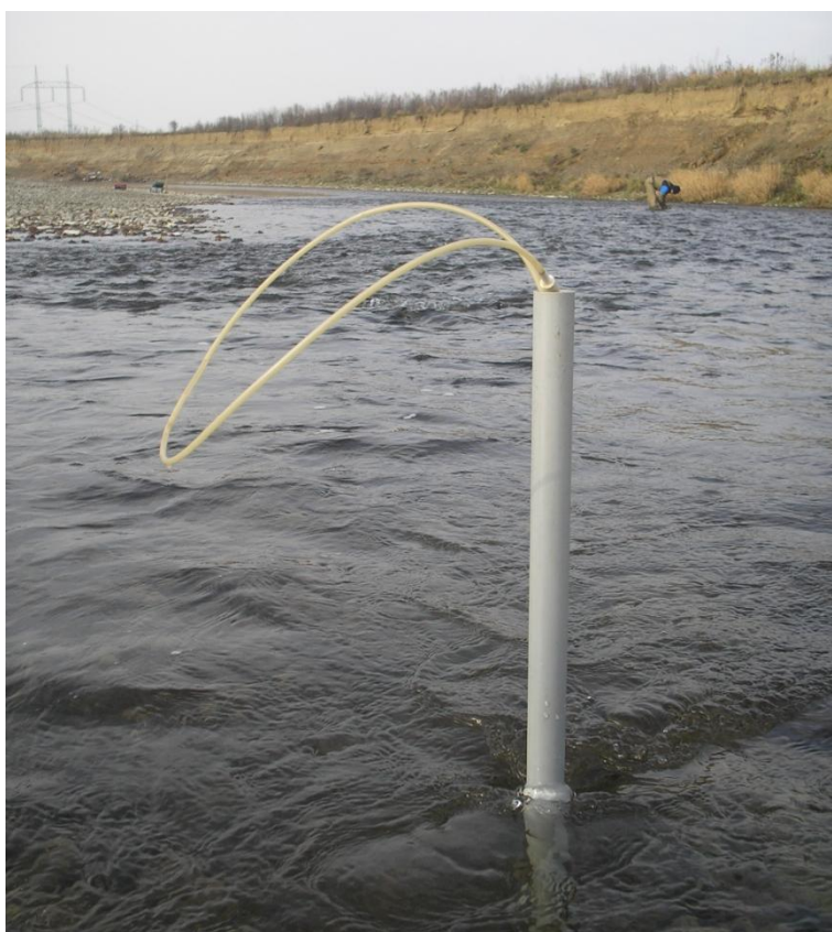
Příloha 6: Sonda připravená pro odběr intersticiální vody. Lokalita Bečva-Osek; © Michaela Galová
