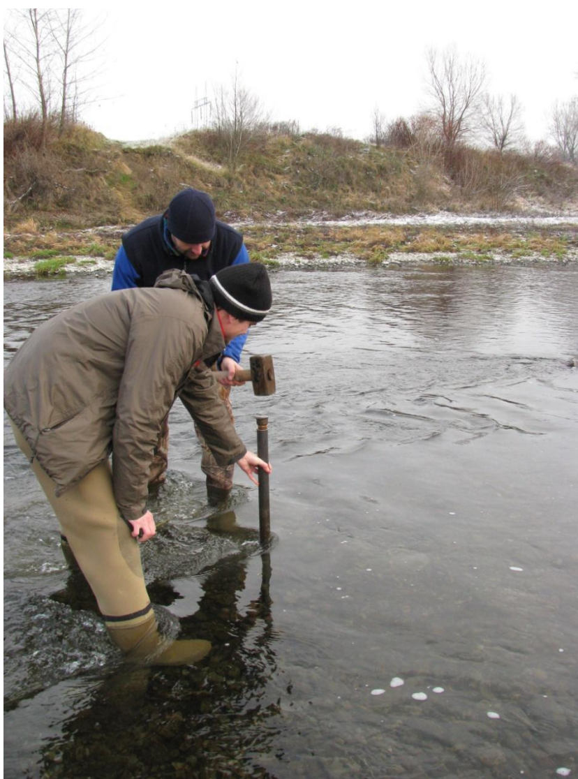
Příloha 4: Upevnění sondy do sedimentu na dně říčního koryta. Lokalita Bečva-Osek; © Pavel Kožený
