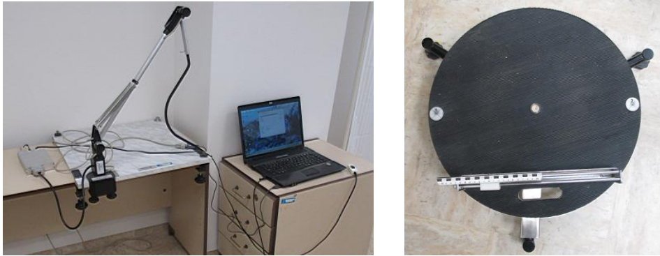
Obrázek 23. Diagnostický systém DTP-2. Polohový snímač, základní deska, ovládací jednotka, osobní počítač [vlevo], otočná plošina [vpravo] (fotoarchiv autorky, 2013).
