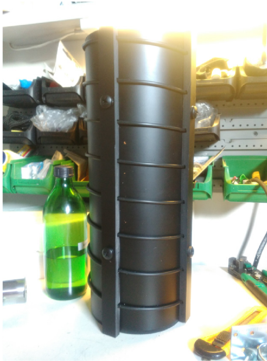
Fotografia 10 Osadenie držiakov drôtu na PVC rúru
