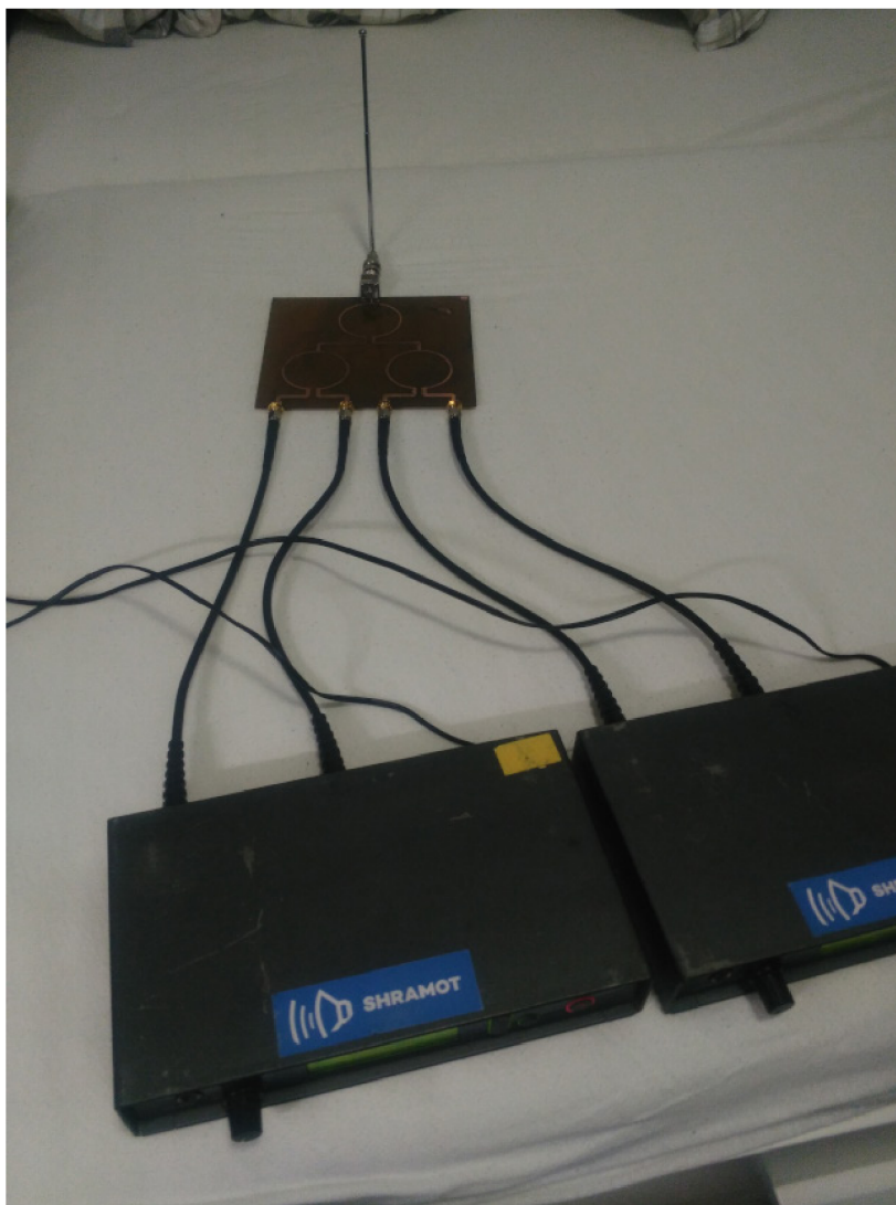
Fotografia 1 Testovanie prvotného prototypu signálového rozbočovača s prijímačmi Sennheiser
