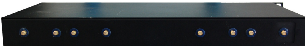
Obr. 24 Zadný panel splitteru s SMA konektormi
