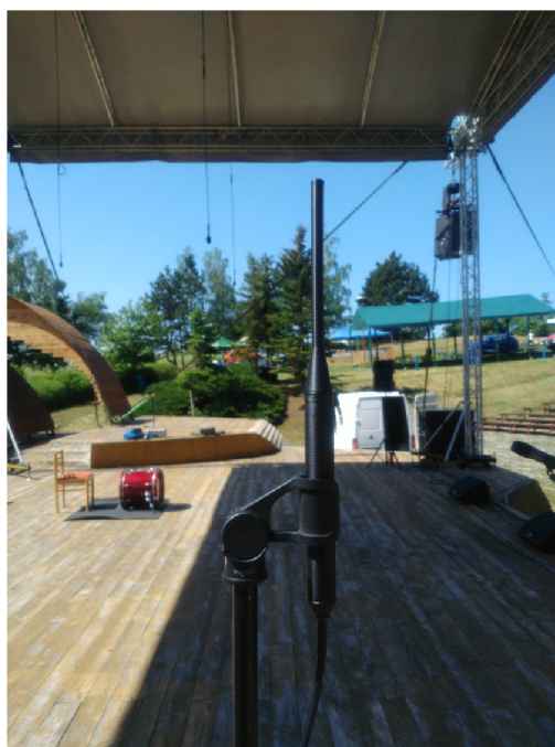
Fotografia 5 Koaxiálna anténa testovaná pri reálnom použití
