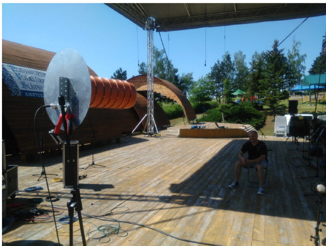
Fotografia 7 Druhá konštrukčná verzia helix antény testovaná pri reálnom použití
