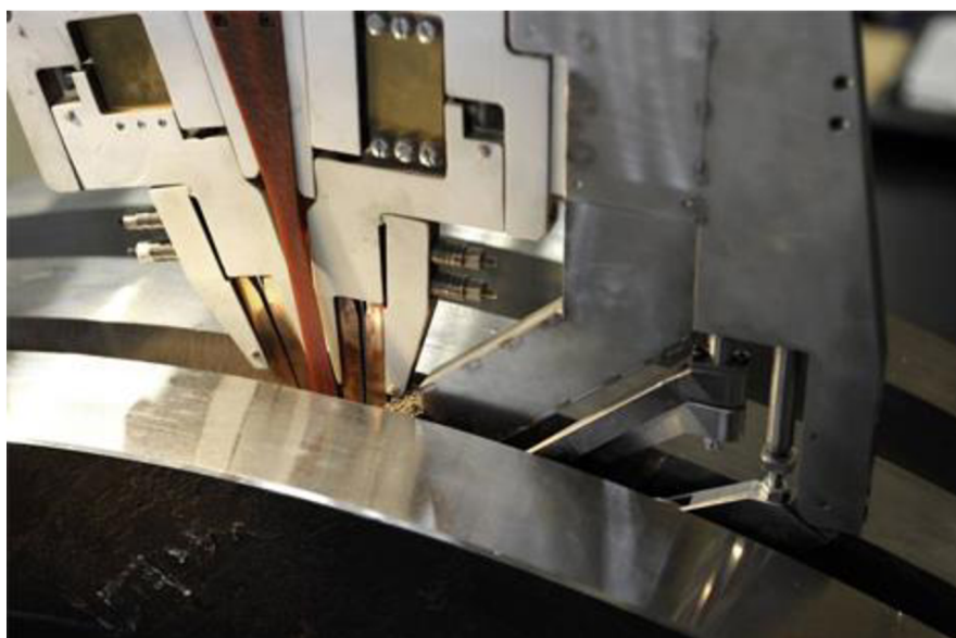
Obr. 20 - Svařovací hlava ke svařování do úzkého úkosu [24]
