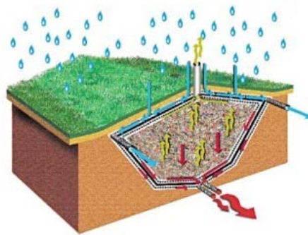
Obr. č. 7 Jednokomorová záchytná studna
