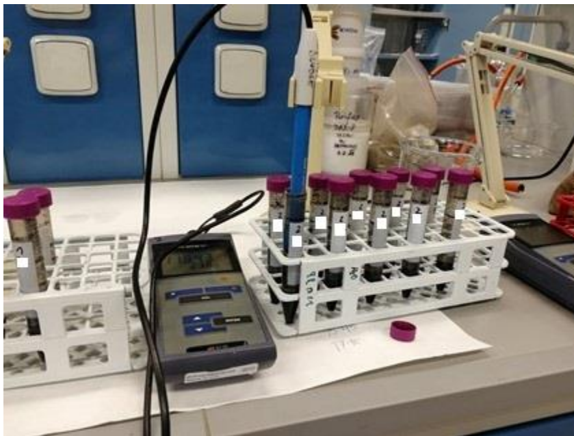
Obrázek 4: Měření pH suspenze pyrolyzovaného čistírenského kalu s deionizovanou vodou (foto: Kunteová, 2021).
