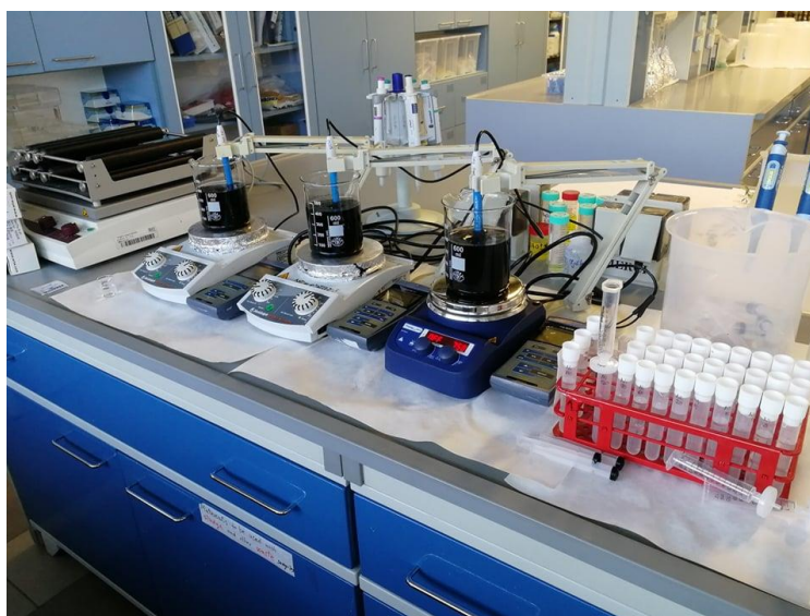
Obrázek 6: Experimentální uspořádání pro stanovení sorpční kinetiky (foto: Kunteová, 2021).
