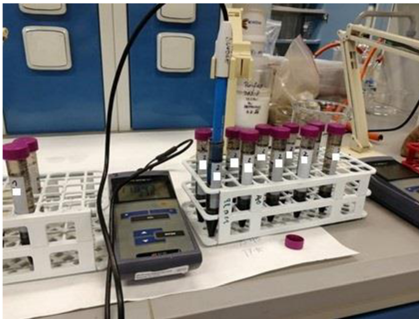
Obrázek 4: Měření pH suspenze pyrolyzovaného čistírenského kalu s deionizovanou vodou (foto: Kunteová, 2021).
