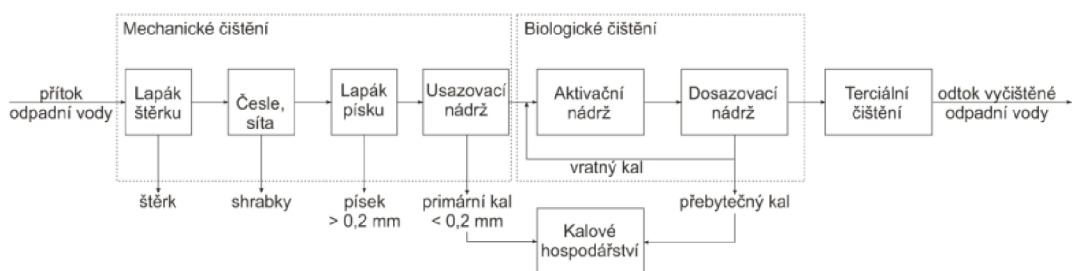
Obrázek 1: Blokové schéma standardní technologické linky čistírny městských odpadních vod (Junga a kol., 2015).
