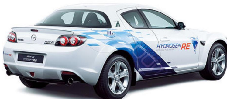
Obrázek 7: Automobil s přímým spalováním vodíku Mazda RX-8 Hydrogen [21].
