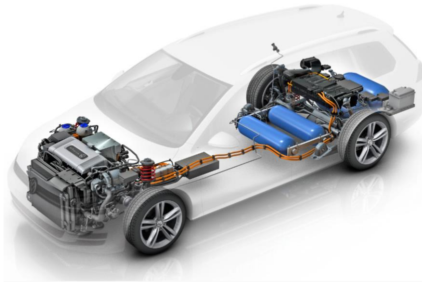
Obrázek 12: Automobil se spalovacím motorem a palivovým článkem VW Golf Variant HyMotion [28].
