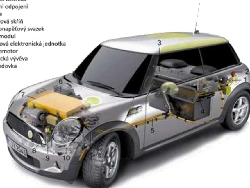
Obrázek 20: Mini E s elektromotorem vpředu [39].
