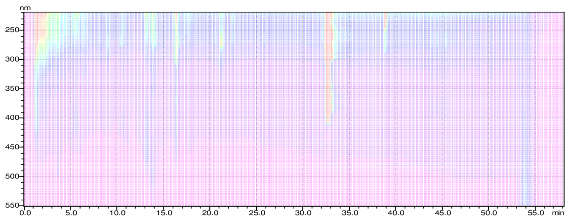
Obr. 14: Chromatografický záznam roztoku BaP ( c = 20 \text{ mg/L} ) po fotooxidaci v n -hexanu (Chromatografické podmínky, viz obr. 11 : detekce 220 nm – 550 nm)
