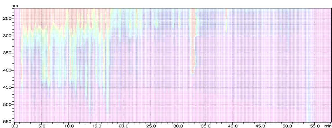
Obr. 17: Chromatografický záznam roztoku BaP ( c = 20 \text{ mg/L} ) po fotooxidácii v methanolu (Chromatografické podmínky: viz obr. II ; detekce 220 nm – 550 nm)
