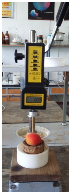
Obrázek č. 11: Stanovení pevnosti plodů penetrem
