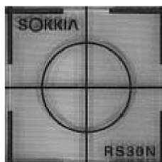
Obr. 3 Nalepovací odrazný terč Sokkia [autor]
