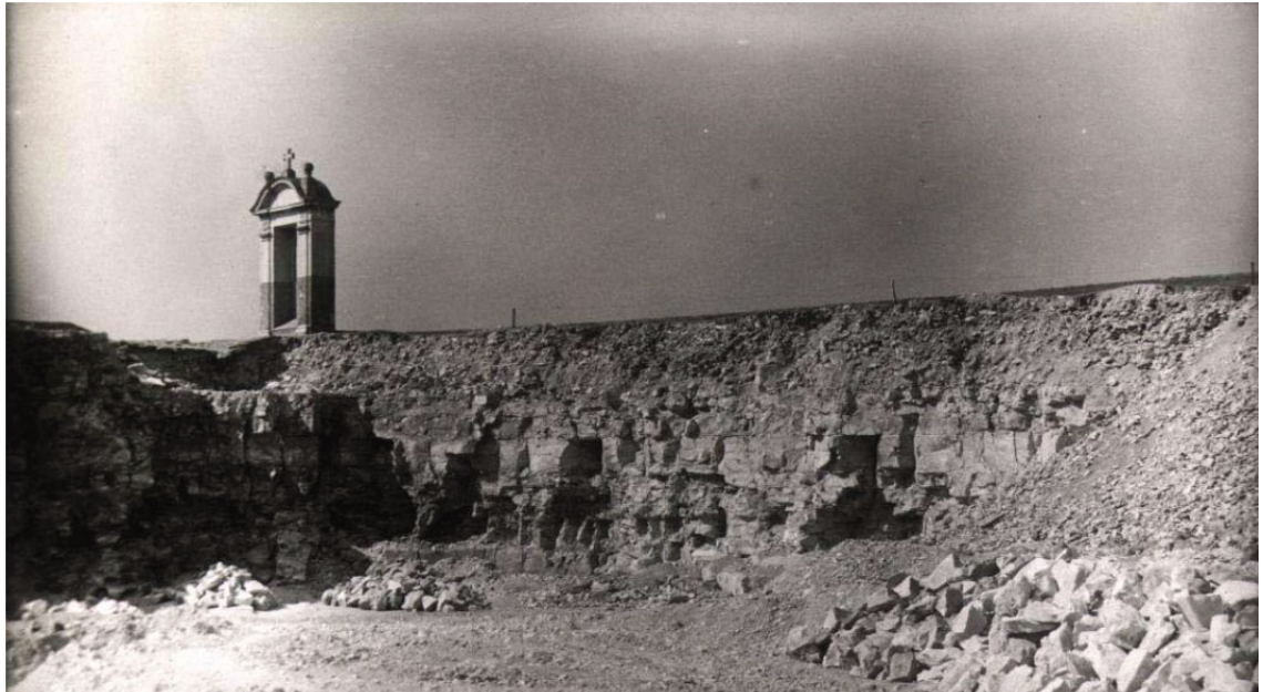
Obrázek č. 3: Povrchová těžba opuky v pražském Břevnově u čtvrté kaple poutní cesty do Hájku před sto lety ( URL2 )
