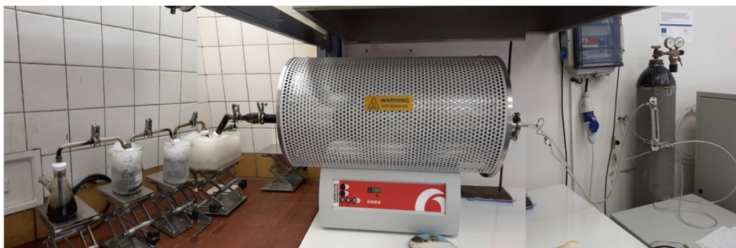
Obrázek 2: Trubková pec Carbolite Gero Ltd., Hope, UK se zdrojem dusíku a systémem pro odběr těkavých plynů
