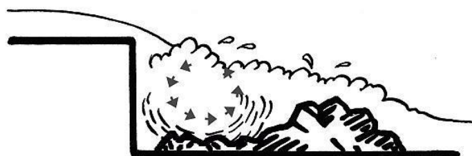
Obr. 8. Spádová deska svislá (Nebezpečné jezy 2014)
