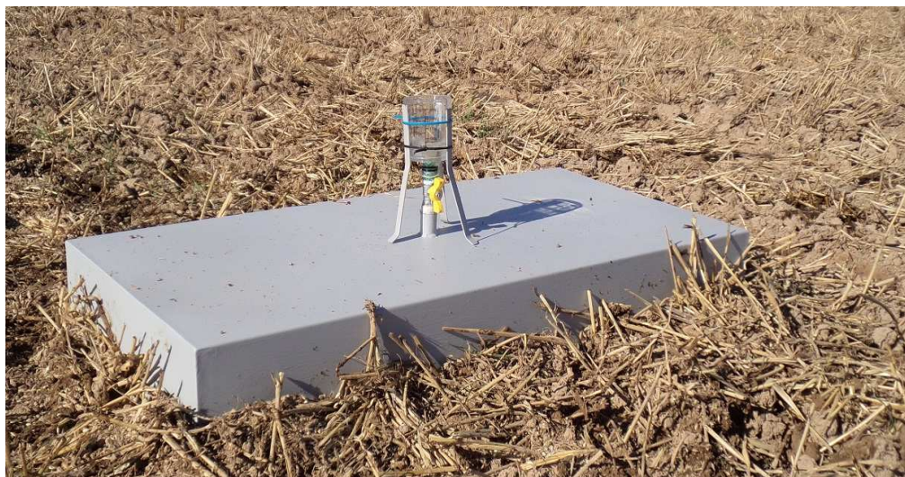
Obrázek 22 - Měření úniku plynů po aplikaci diskového aplikátoru [foto autor]
