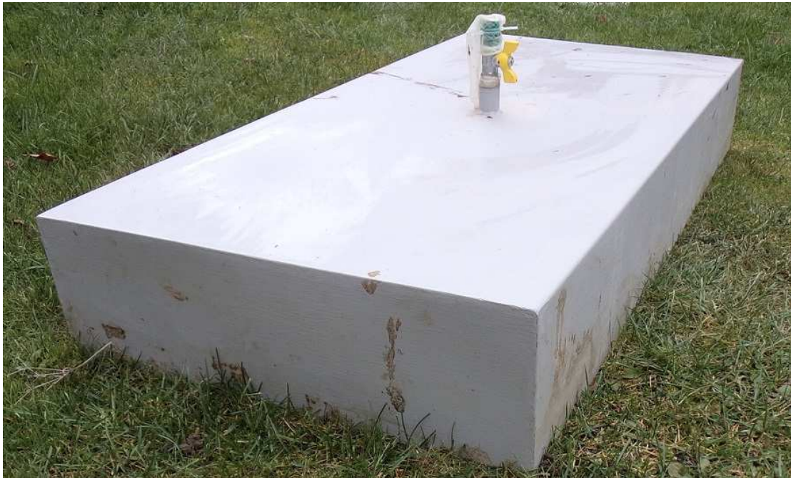
Obrázek 20 - Kvádrový plechový svařenec s uzavíratelným kohoutem [foto autor]
