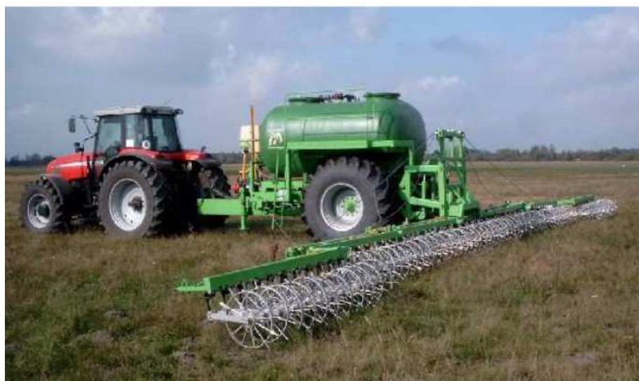
Obrázek 3 - Aplikátor pro hnojení kapalnými minerálními hnojivy injektáží do půdy[7]
