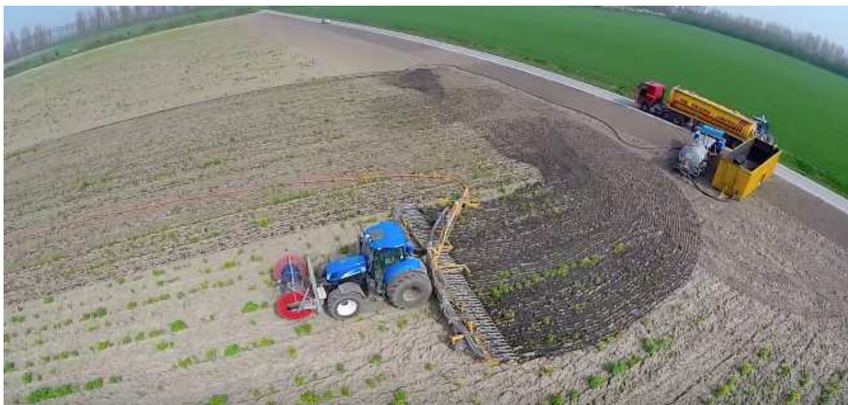
Obrázek 15 - Aplikace pomocí neseného aplikátoru zásobovaného čerpadlem ze zásobní stacionární cisterny pomocí hadice [25]
