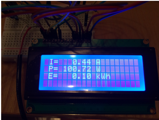
Obr. 3.6: Měření spotřeby 100 W žárovky realizovaným zařízením.
