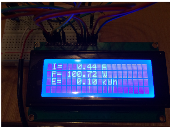
Obr. 3.6: Měření spotřeby 100 W žárovky realizovaným zařízením.
