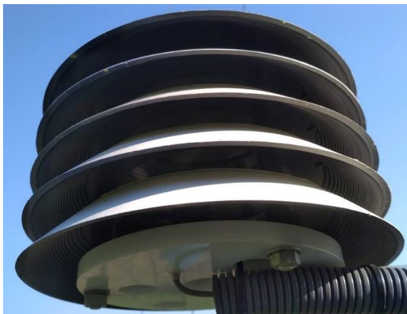
Obrázek č. 2: Radiační kryt pro měření teploty vzduchu
