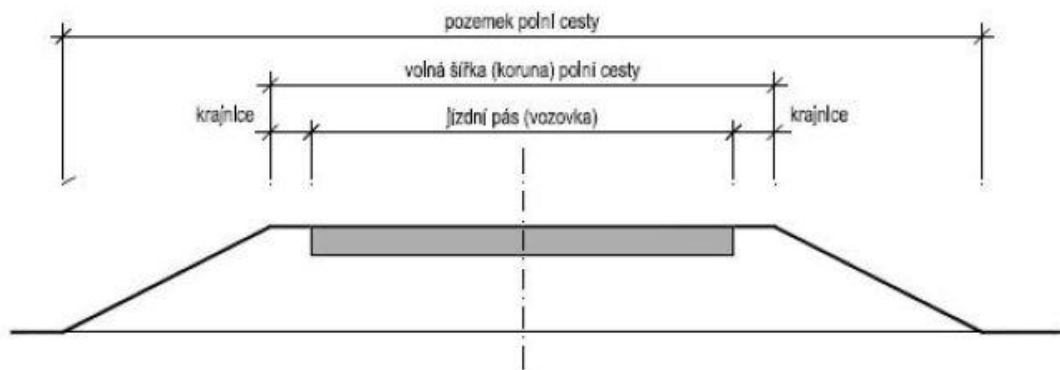
Obrázek č. 4 - Schematické znázornění šířkového uspořádání zpevněné polní cesty v náspu (ČSN 73 6109).
