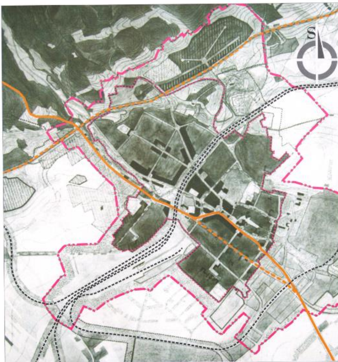
8. Směrný územní plán Chomutova z roku 1956. Čerchovaná fialová čára ukazuje rozsah tzv. ochranného uhelného piliře, na kterém byla povolena stavební činnost; plná světle hnědá čára je stávající trasa silnice I./7, čárkované světle hnědé čáry vyznačují plánové stavby silnic I./7 a I./13.
