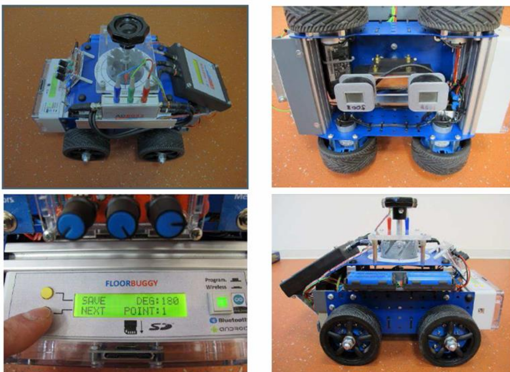
Obr. 4.3 Měřicí vozítko – celkový náhled, upevnění elektromagnetické cívky, ovládací panel [28]
