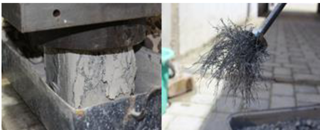
Obr. 5.1 Destruktivní zkouška referenčních těles – drátkobetonové krychle; separace drátků (vpravo)
