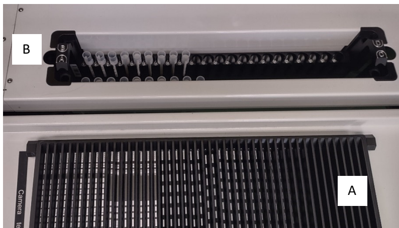
Obrázek 13: Automatický analyzátor DYNA-BLOT automatik – A) inkubační vanička se stripy. B Stojan s patientskými vzorky sér (Zdroj: Fotografie je pořízena autorkou práce na KL DIA-GON, s.r.o. Cheb).
