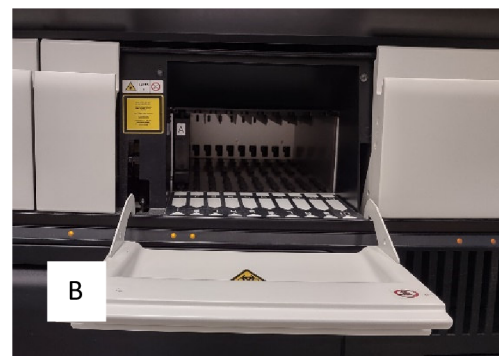
Obrázek 7: Analyzátor LIAISON XL – A) Chlazený prostor pro reagenční integrály, B) prostor pro vzorky (Zdroj: Fotografie je pořízena autorkou práce na KL DIA-GON, s.r.o. Cheb).
