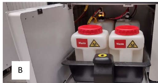
Obrázek 6: Analyzátor LIAISON XL – A) Prostor pro nádobu na pevný odpad, zásobní lahve s destilovanou vodou a promývacím roztokem, B) Prostor pro nádobu na tekutý odpad (Zdroj: Fotografie je pořízena autorkou práce na KL DIA-GON, s.r.o. Cheb).
