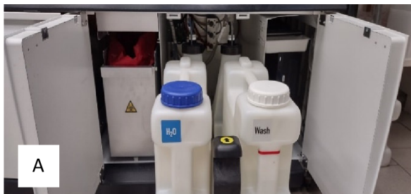
Obrázek 6: Analyzátor LIAISON XL – A) Prostor pro nádobu na pevný odpad, zásobní lahve s destilovanou vodou a promývacím roztokem, B) Prostor pro nádobu na tekutý odpad (Zdroj: Fotografie je pořízena autorkou práce na KL DIA-GON, s.r.o. Cheb).
