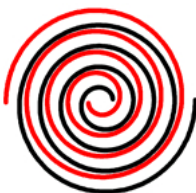
Obrázek 2.2: Schéma kompresoru SCROLL[102]
