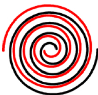
Obrázek 2.2: Schéma kompresoru SCROLL[102]
