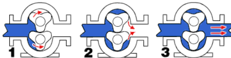
Obr. 5.8.1: Princip čerpadla s rotačními písty [30]
