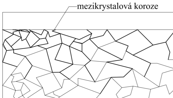
Obr. 2.1.6: Mezikrystalová koroze; upraveno autorem [4]
