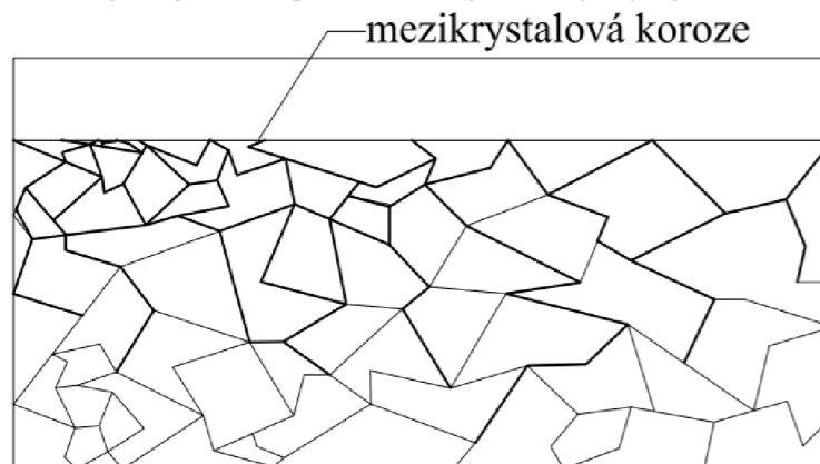
Obr. 2.1.6: Mezikrystalová koroze; upraveno autorem [4]
