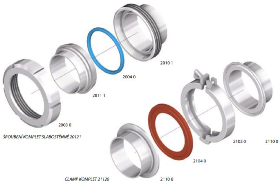
Obr. 4.3.1: Clampový a mlékárenský spoj [13]
