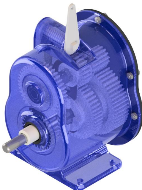
Obrázek 17: Hotový model převodovky, část skříně zprůhledněna, obrázek vyrendrován pomocí Inventor studio
