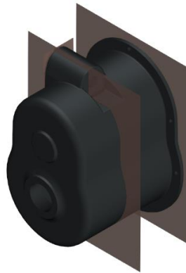
Obrázek 16 Větší část skříně po rozdělení, hnědé plochy jsou pracovní roviny
