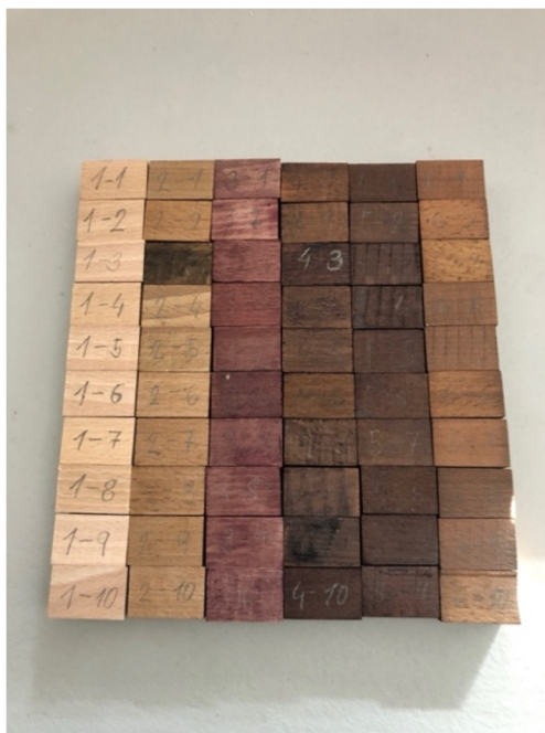
Obr. 7: Zkušební tělesa po modifikaci (vlastní)
