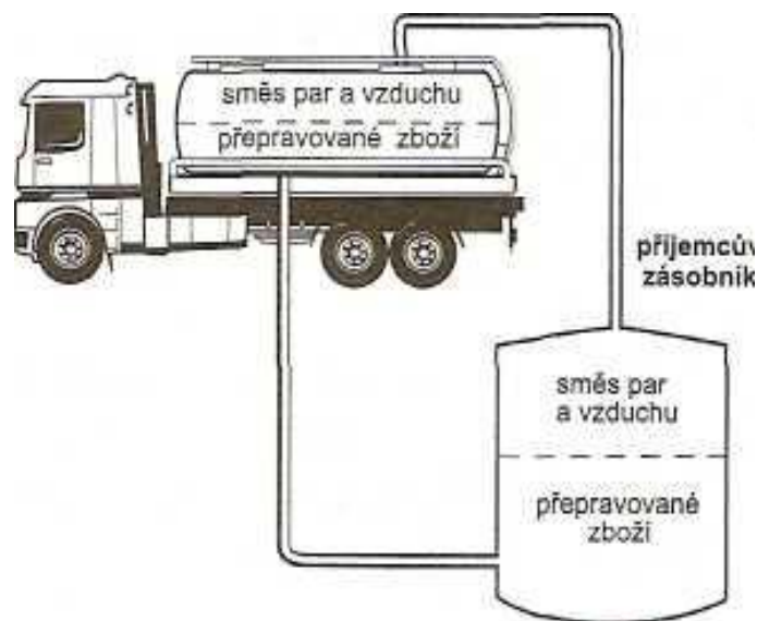
Obr. 2. Vyprazdňování nádrže do zásobníku příjemce
