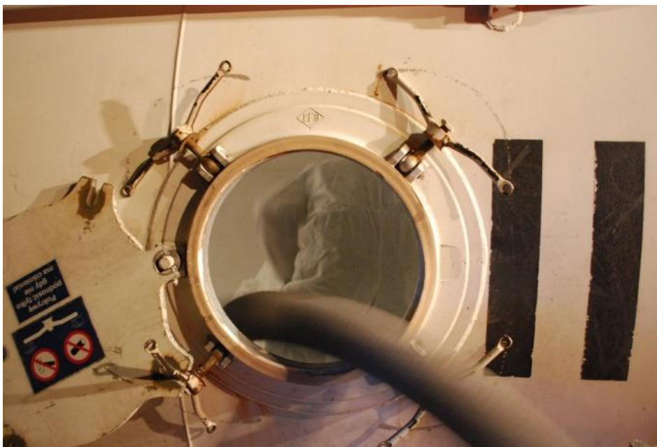
Obr. 29. Dočištění havarované cisterny zevnitř
