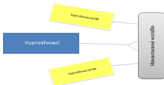
Obr. 38. Možné schéma při vyproštění havarované cisterny
