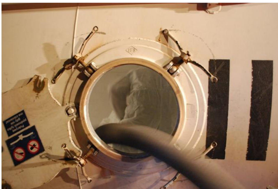
Obr. 29. Dočištění havarované cisterny zevnitř
