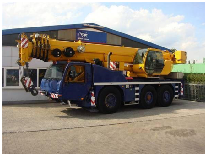
Obr. 13. Vyprošťovací autojeřáb do 50 tun
