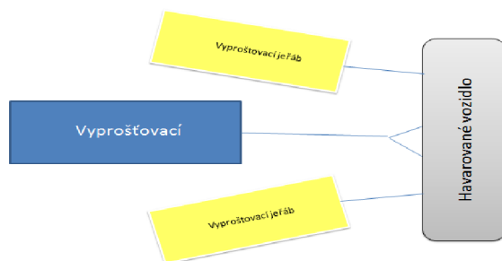
Obr. 38. Možné schéma při vyproštění havarované cisterny
