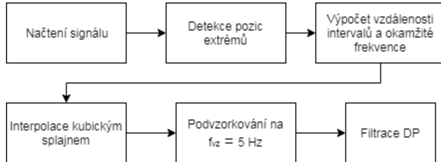
Obrázek 4.12: Blokové schéma metody vycházející z frekvenční modulace.
