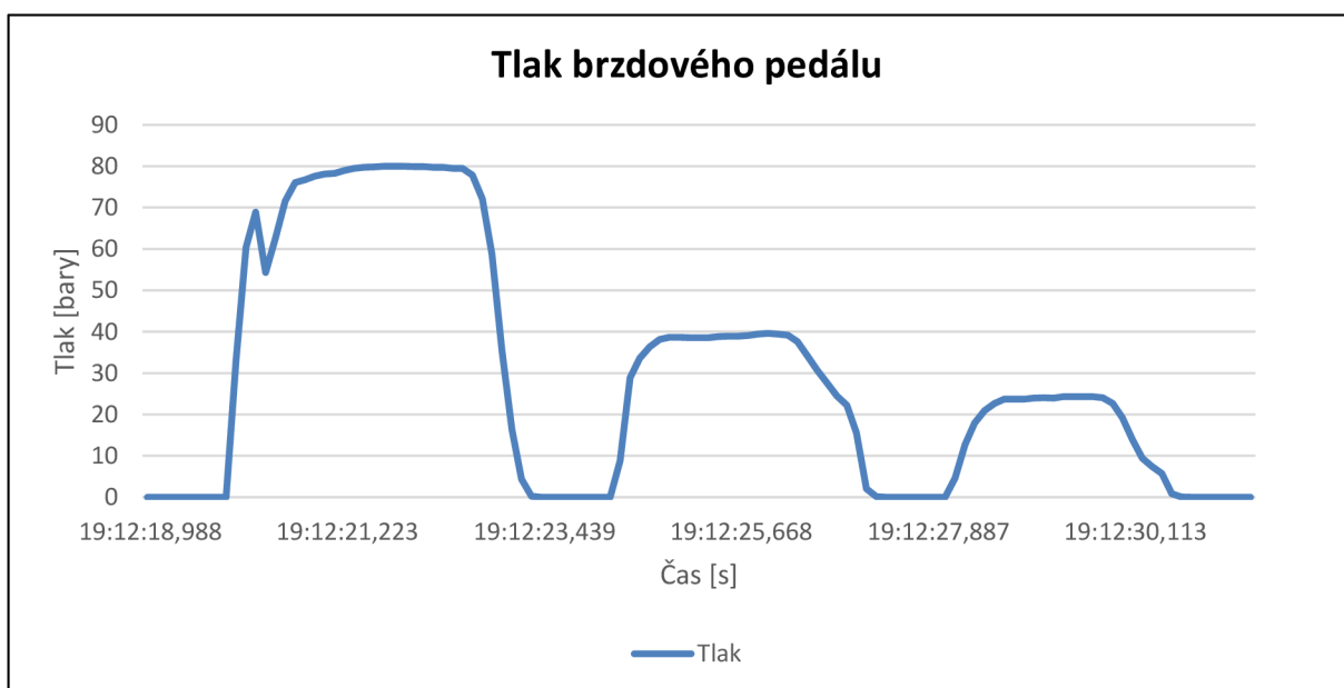
Graf 4: Grafické znázornění tří sešlápnutí brzdového pedálu (v barech) v závislosti na času [10]
