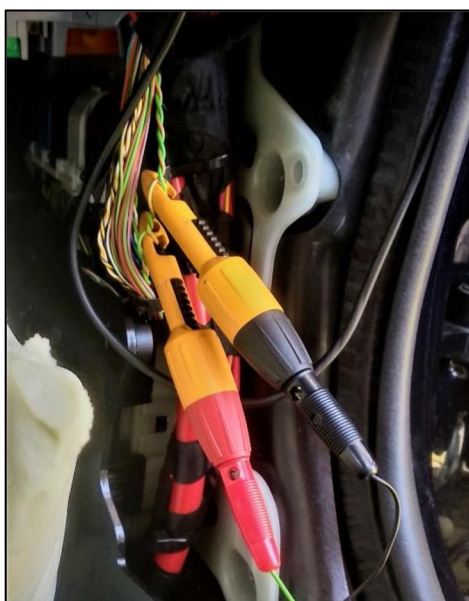
Obr. 23: Napojení na CAN sběrnici, první měření. Zelený vodič (CAN_H), žlutý vodič (CAN_L) [10]
