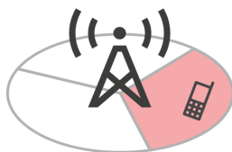
Obrázek 4: Zjištění polohy zařízení metodou CGI
