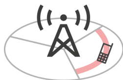
Obrázek 5: Zjištění polohy zařízení metodou CGI+TA
