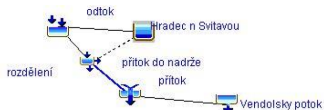
Obrázek 3.6 Schéma pro výpočet transformace povodňové vlny
