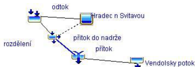
Obrázek 3.6 Schéma pro výpočet transformace povodňové vlny
