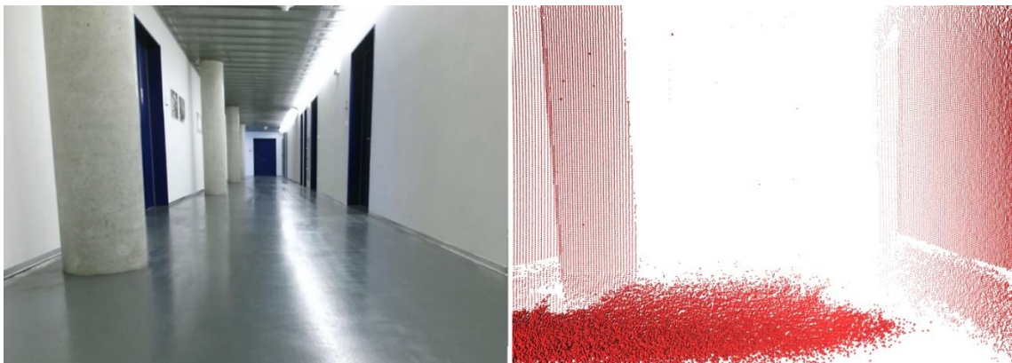
Obrázek 19: Chybné měření vzdálenosti
