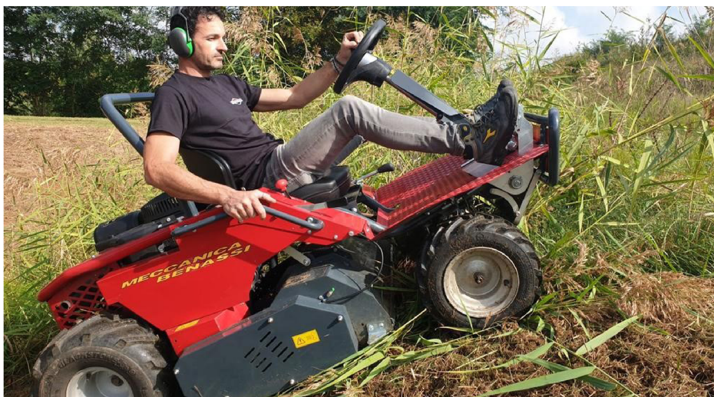
Obr. 21: Svahový mulčovač v akci.
