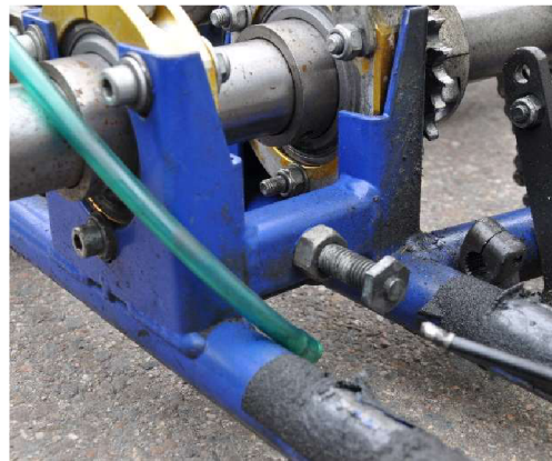
Obr. 5.1 Svary na uložení zadní osy
