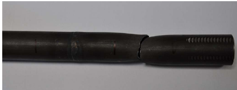
Obr. 5.20 Přetržení celistvé trubky
