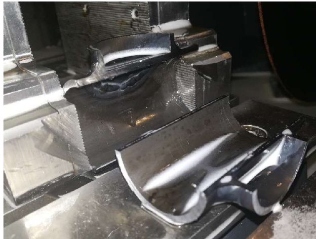
Obr. 5.5 Řezání vzorků na metalografické pile
