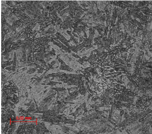
Obr. 5.11 Mikrostruktura TOO – MAG
