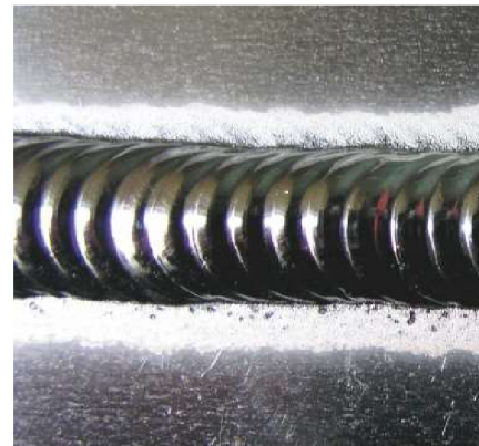
Obr. 3.4 Svar v pulsním režimu [27]
