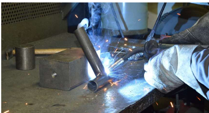
Obr. 5.3 Svařování vzorku metodou MAG
