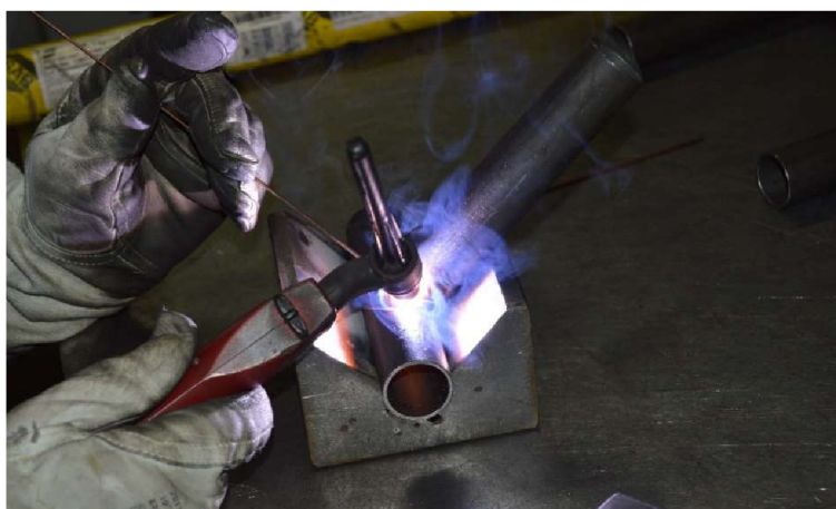
Obr. 5.4 Svařování vzorku metodou TIG
