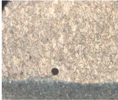
Obr. 4.2 Vměstek ve svaru
